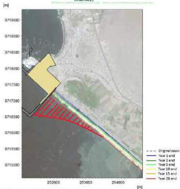
Figura 8.5-47 Modelado de la evolución en el escenario con proyecto - sin bypass (sur de punta Chancay)
